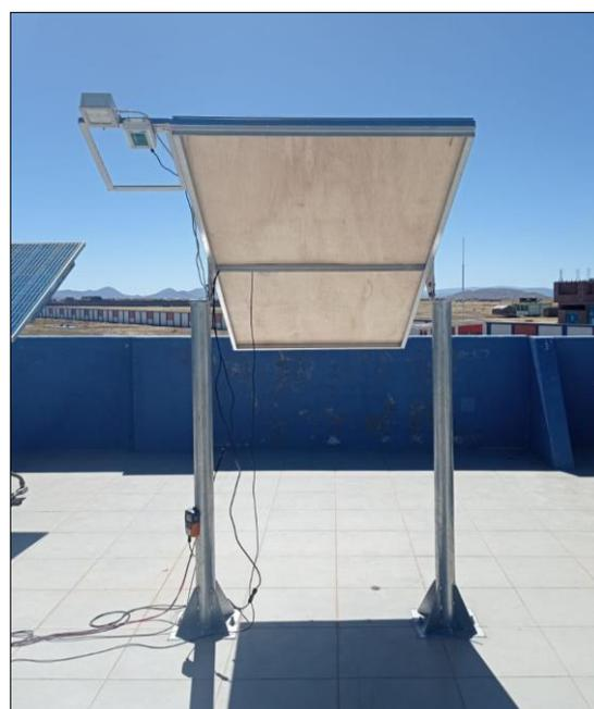
Figura 7. Cubierta del lado no expuesto para determinar bifacialidades.
