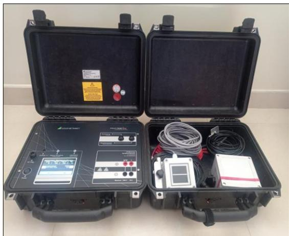
Figura 2. Trazador de curvas I-V Gossen Metrawatt PROFITEST PV
