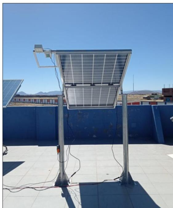
Figura 4. Módulo fotovoltaico bifacial
