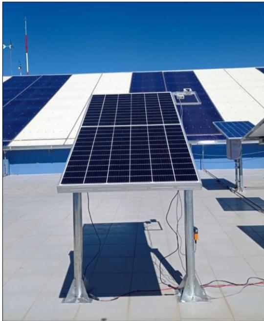
Figura 8. Lado frontal del módulo fotovoltaico bifacial.
